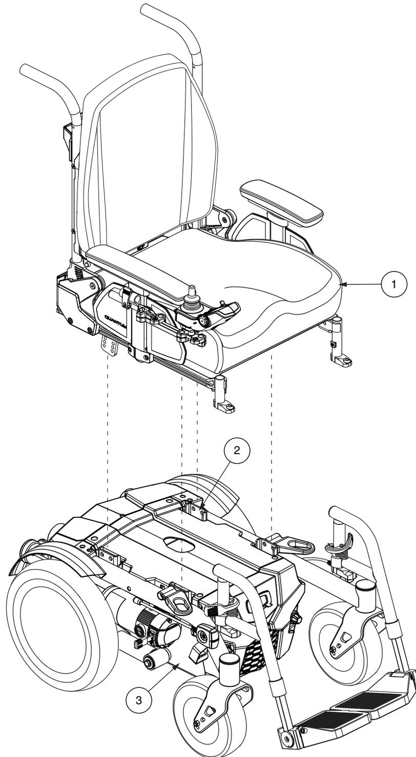
Figura 6. Esquema de montaje del Aspen
