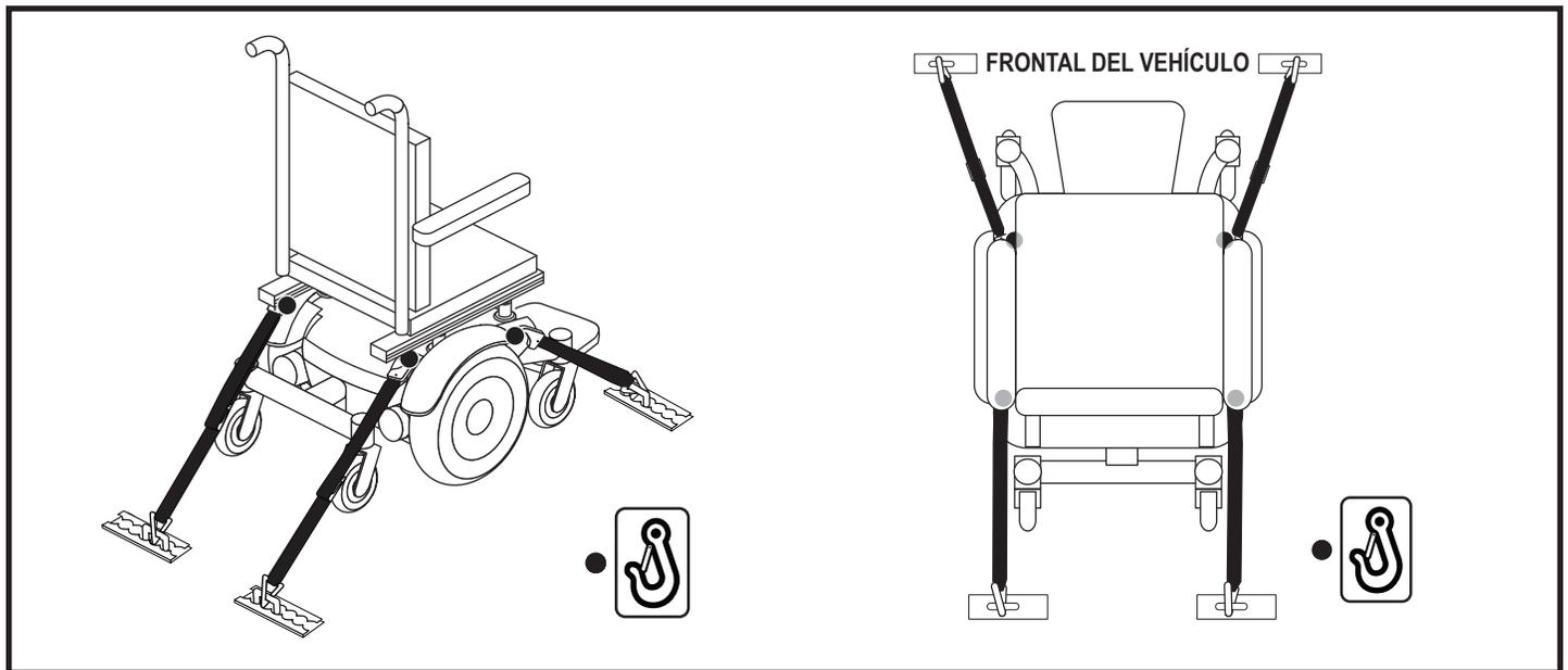
Figura 10. Sistema de sujeción durante el traslado (silla sin ocupante)
